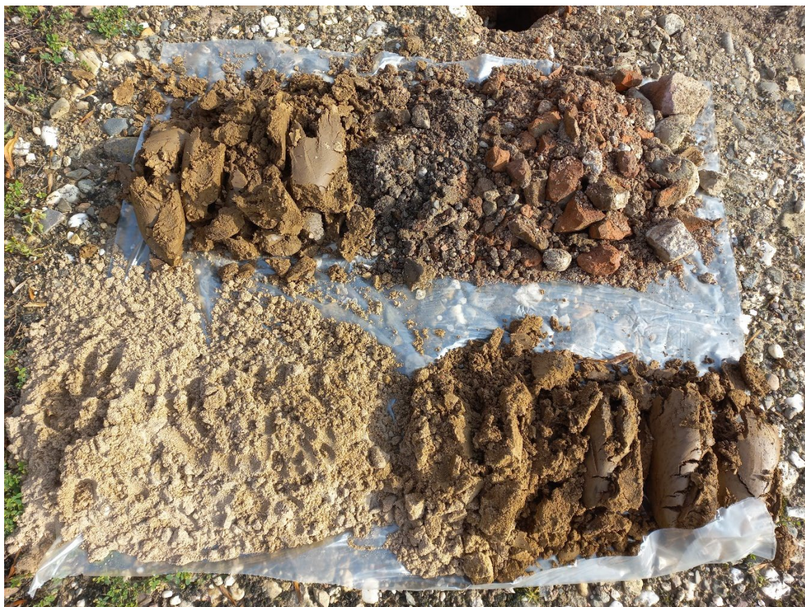
Afbeelding 4.3: Boring 14. Top ligt rechtsboven (granulaat/puin), boven eerste meter, onder tweede meter.
