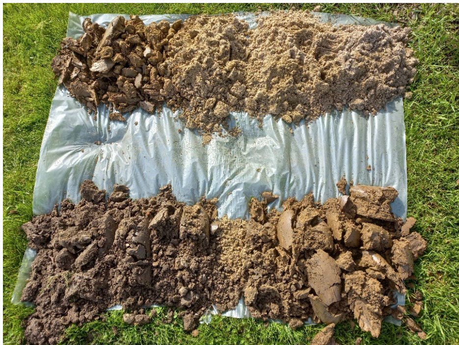
Afbeelding 4.1: Boring 16 (top linksonder, per meter uitgelegd).
